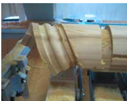
CNC-Fertigung eines 180-Grad-Krümmlinge.
