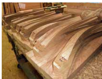
CNC-Fertigung verschiedener Krümmlinge.
